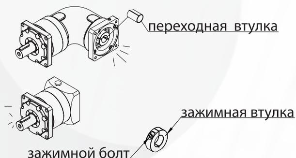
1. Вставляйте вал двигателя во входное отверстие редуктора медленно, чтобы избежать ударов, и убедитесь, что поверхности фланца двигателя и фланца редуктора плотно прижаты друг к другу. Затяните болты крепления фланца двигателя в соответствии с указанным моментом затяжки. (См. таблицу 1)
